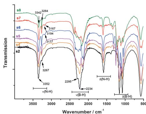
**Figure 8.** Fourier transform infrared spectroscopy data for  $\text{Mn}(\text{BH}_4)_2 \cdot 6\text{NH}_3$  (s2),  $\text{Mn}(\text{BH}_4)_2 \cdot 6\text{NH}_3$ - $\text{Mn}(\text{BH}_4)_2$  (5:1, s4), (4:2, s5), (3:3, s6), (2:4, s7) and (1:5, s8).
